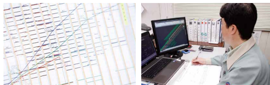
発注図面の平面図、縦断面図、横断面図をもとにパソコンで3次元設計データを作成
