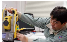
USBメモリの3次元設計データをTSに取り込む
