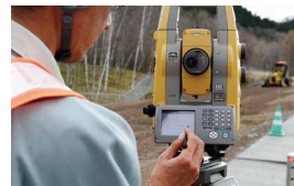
TSの備え付け。3次元座標より位置情報を取得する
