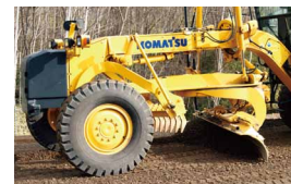
モーターグレーダのブレードは、3次元設計データをもとに自動で高さを調整
