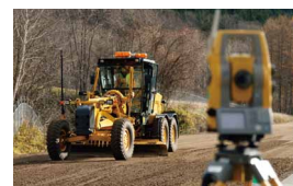
位置情報を取得すれば、後はTSがモーターグレーダを自動追尾する
