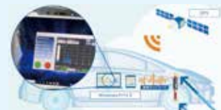
ACTUS はどんな車両にも取り付けが可能。路面データと GPS データを統合し、リアルタイムで計測データをモニタリングできます。
