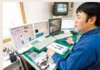
アスファルトプラント製造・出荷操作盤
