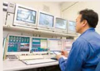
生コンクリート製造・出荷操作盤
