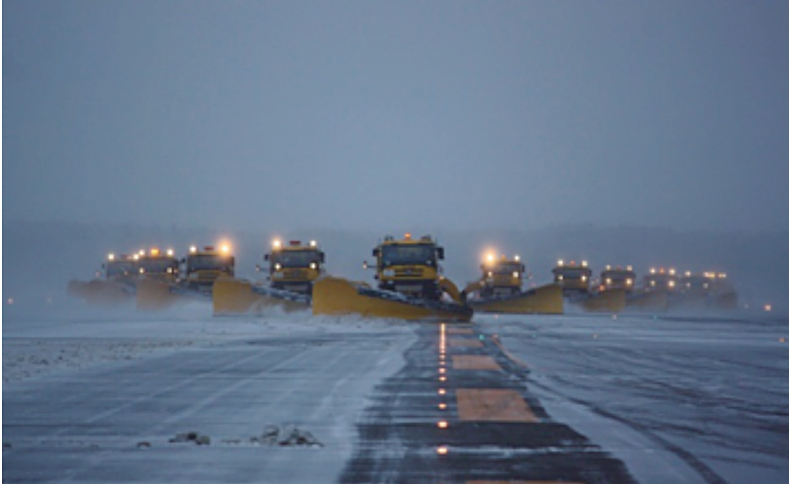
写真1 滑走路除雪作業（運航時間内一方向除雪）（写真提供：地崎道路株式会社）
